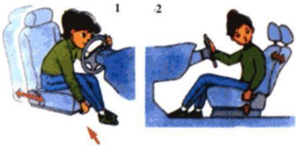
Hình 2.16: Điều chỉnh ghế lái và đệm tựa
