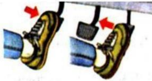
Hình 3.16: Đạp bàn đạp ly hợp và nhả bàn đạp ga - Tăng số: Vào các số yêu cầu thao tác nhẹ nhàng;
