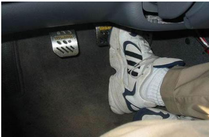
Hình 3.7: Điều khiển ga để giảm số
