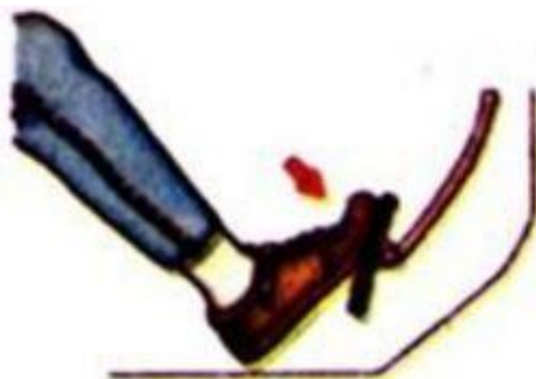
Hình 3.4: Điều khiển ga để tăng tốc độ
