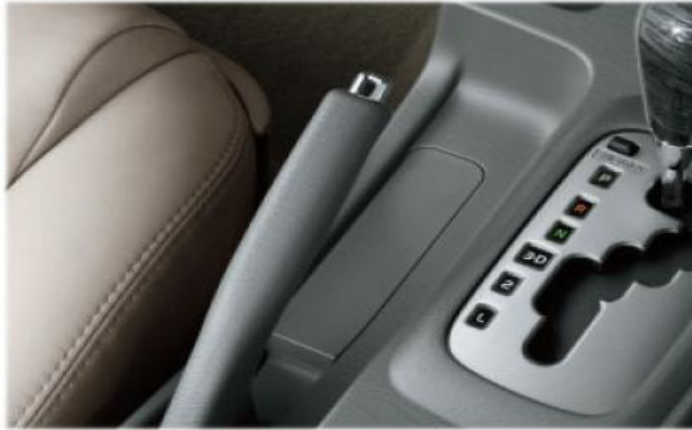
Hình 2.12: Cần điều khiển phanh tay
