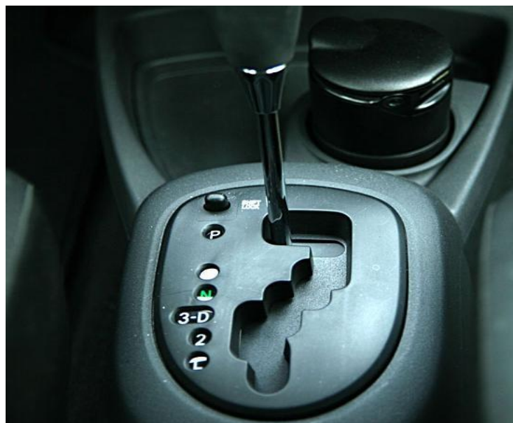
Hình 2.25:Điều khiển cần số hộp số tự động
