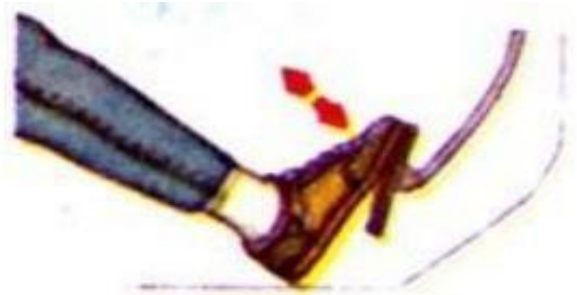
Hình 3.6: Điều khiển ga để duy trì tốc độ chuyển động đều
