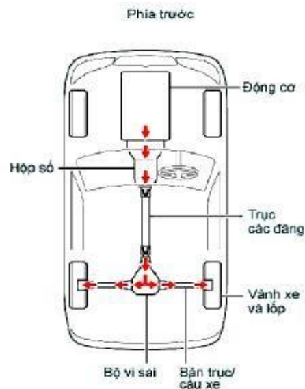
Hình 1.10 Hệ thống truyền lực cầu sau chủ động
