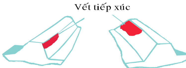
Hình: Vết tiếp xúc khi vành răng gần đường tâm cùi thom (vị trí cùi thom đúng).
