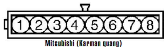
Hình . Sơ đồ vị trí chân và cách kiểm tra cảm biến Karman quang
