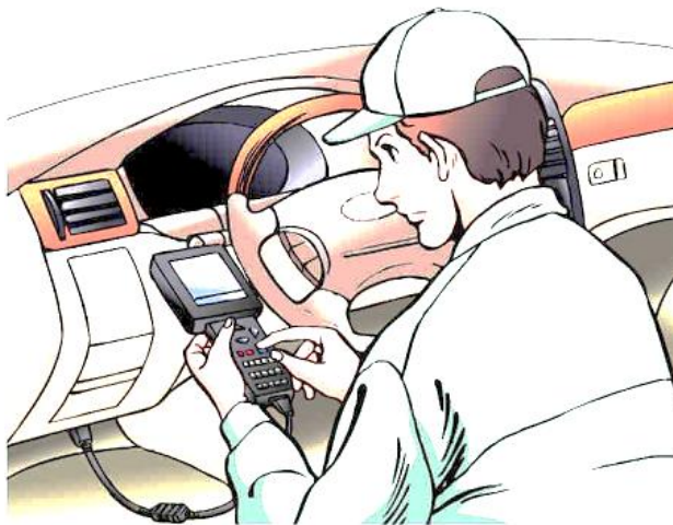
Hình 3.7. Sử dụng hiệu quả máy chẩn đoán để khắc phục hư hỏng.
