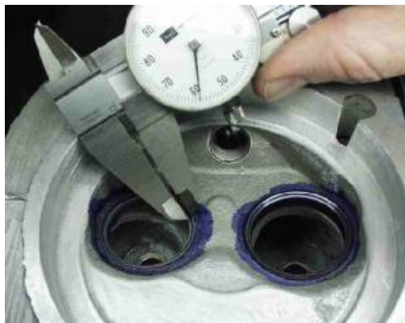
Hình 3.23: Kiểm tra ổ đặt bằng thước cặp
