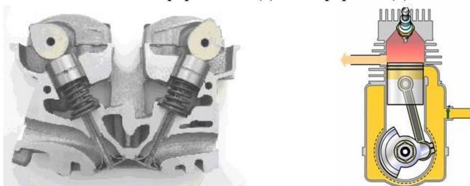
Hình 1.18: Hệ thống phân phối khí loại trực cam đặt trên nắp máy (a) và loại ngăn kéo phân phối (b)
