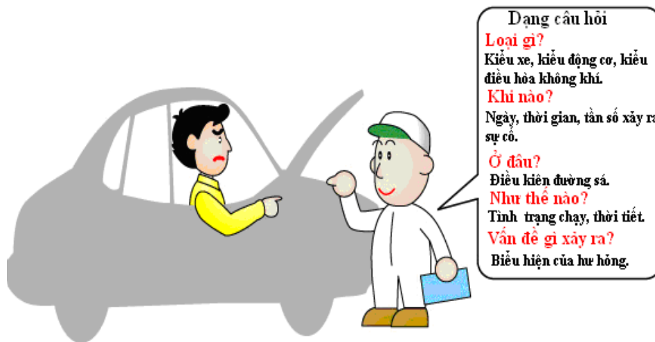
Hình 4.2: Phương pháp xác định hư hỏng hệ thống lạnh
