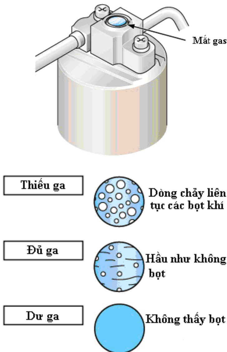
Hình 3.17: Kiểm tra lượng lạnh chất bằng cách quan sát trên mắt gas
