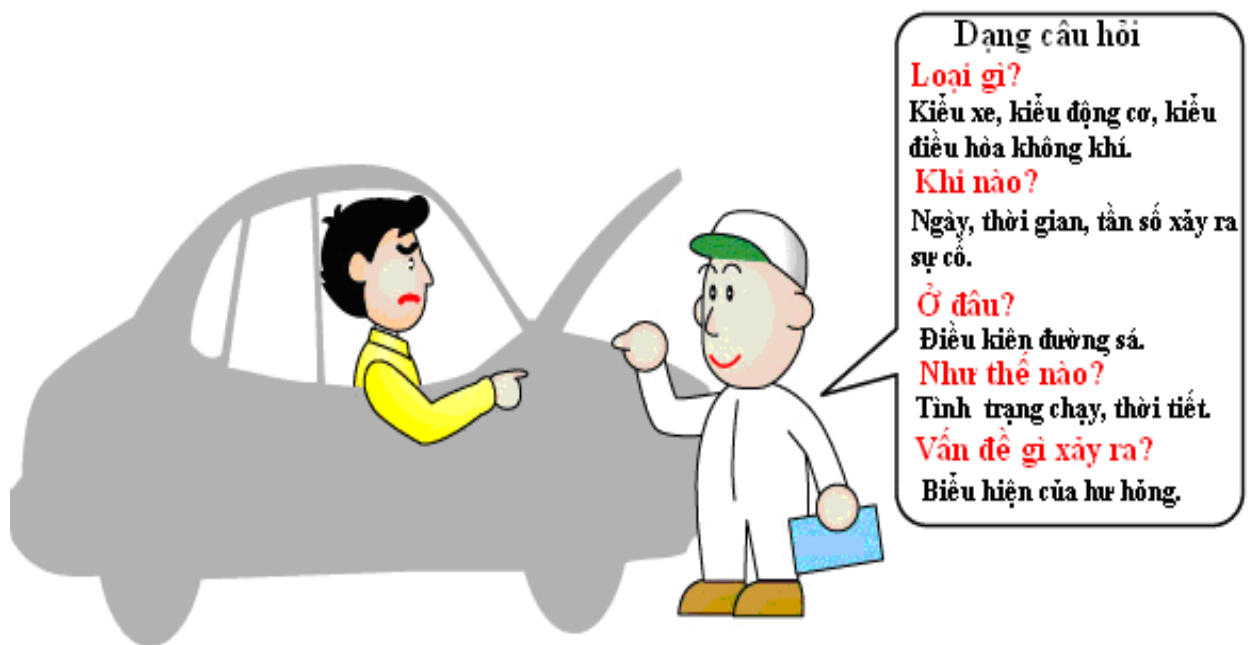
Hình 3.13: Phương pháp xác định hư hỏng hệ thống lạnh
