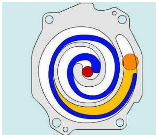
Hình 1.26: Nguyên lý làm việc máy nén kiểu xoắn ốc
