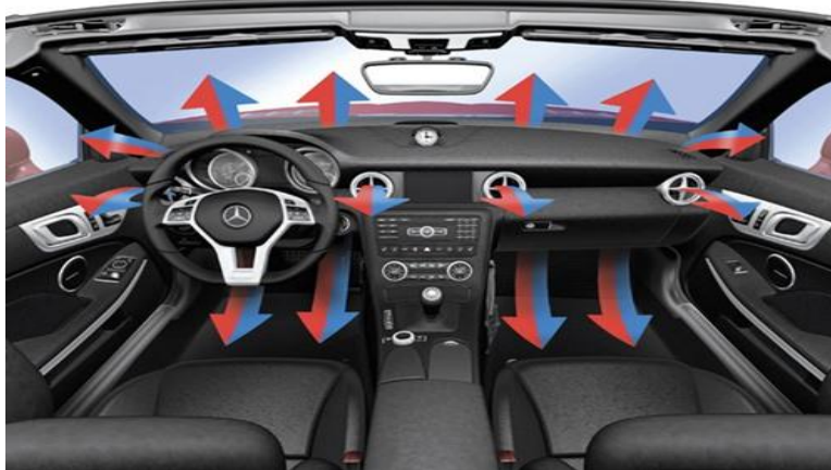
Hình 3.10: Kiểm tra lượng gió ra và độ lạnh của hệ thống
