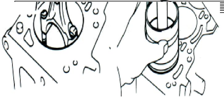
Hình 1.27 Lắp cụm biên piston.
