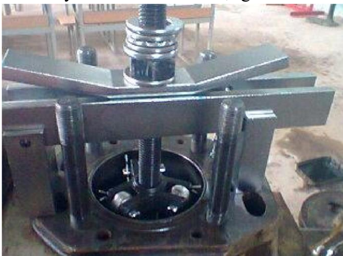
Hình 1.21 Vam tháo xy lanh - Tháo đệm làm kín nước.
