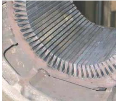
Hình 2- 33. Vệ sinh vỏ và các rãnh của lõi thép Stato
