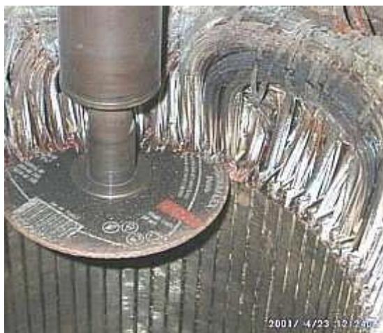
Hình 2-26. Cắt bỏ phần đầu cuộn dây
