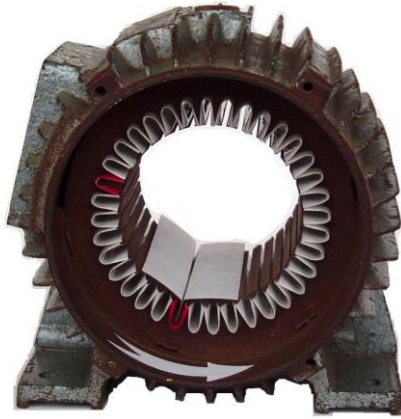
Hình 2 - 36: Lót cách điện DC hoàn chỉnh
